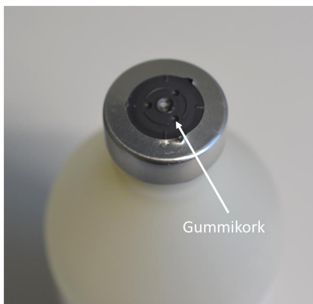
Bilde 2. Beskyttelseslokk fjernes og spiken på slangesettet stikkes inn i midten av gummikorken.
